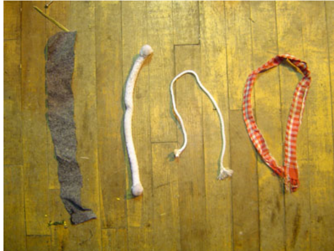
Photos 5. Variétés de mèches capillaires : géotextile, polyester, nylon et coton
